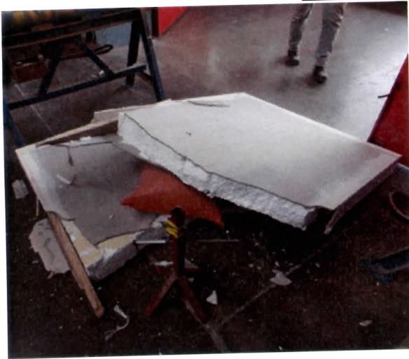
Figura 21. Ensayo de resistencia al impacto paneles TIPO II y TIPO III, muestra 1895-15(5) a) Falla de la muestra, b) detalle de falla sección transversal.
