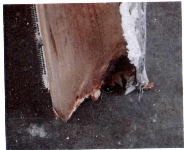
Figura 22. Ensayo de resistencia al impacto paneles TIPO II y TIPO III, muestra 1895-15(5). Detalles de falla de piezas de madera.
