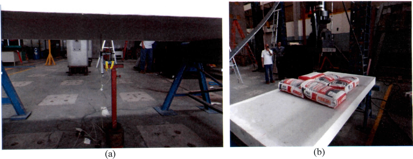
Figura 16. Ensayo de resistencia a carga uniformemente distribuida: a) configuración de sistema de LVDT b) Carga de 200 Kg/m 2 en muestra 1895-15 (1).
