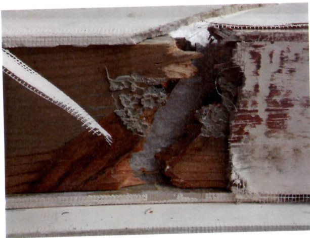
Figura 22. Ensayo de resistencia al impacto paneles TIPO II y TIPO III, muestra 1895-15(5). Detalles de falla de piezas de madera.
