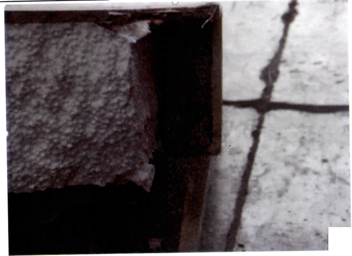
Figura 21. Ensayo de resistencia al impacto paneles TIPO II y TIPO III, muestra 1895-15(5) a) Falla de la muestra, b) detalle de falla sección transversal.
