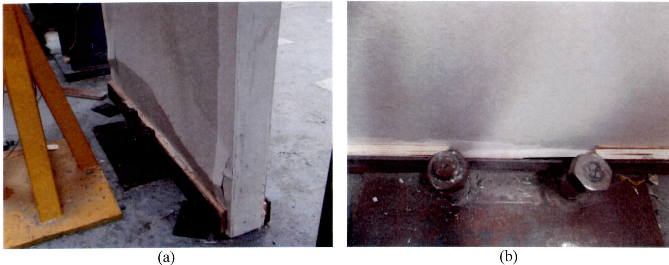
Figura 3. Falla en compresión muestra 1892-15 (1): a) vista posterior, b) vista frontal.
